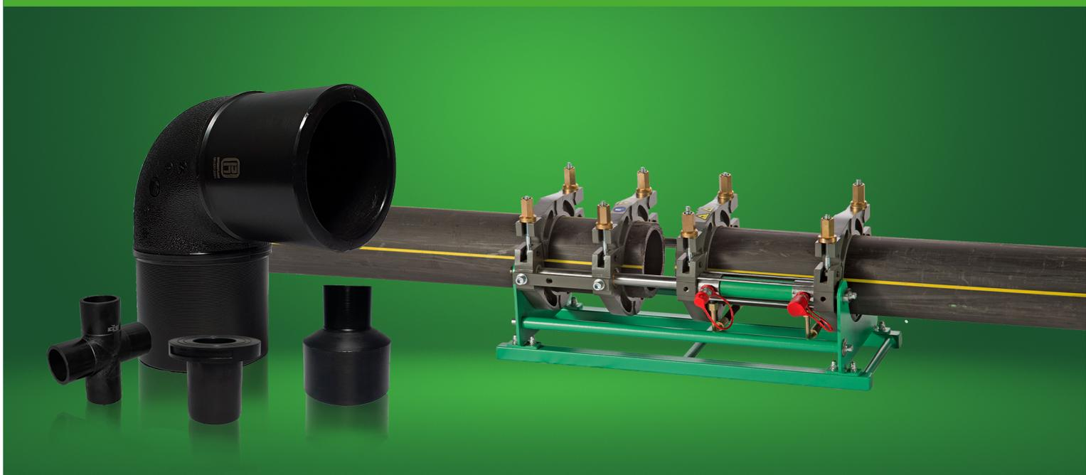
La termofusión es un método de soldadura al tope, simple y rápido para unir tuberías de polietileno y sus accesorios. La superficie de las partes que se van a unir se calientan a temperatura de fusión y se unen por aplicación de presión, con acción mecánica o hidráulica, de acuerdo al tamaño de la tubería y sin usar elementos adicionales de unión.
