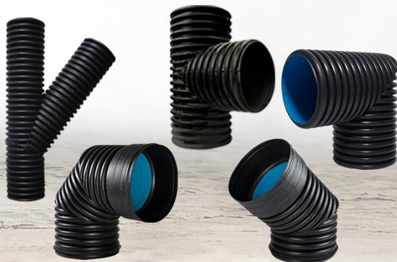
Son accesorios de resina de Polietileno de alta densidad (HDPE) que combina un exterior corrugado anular para mayor resistencia estructural y una pared interior lisa para máxima capacidad de flujo hidráulico, para conducción sin presión, sus dimensiones son desde 110 mm a 1600mm
